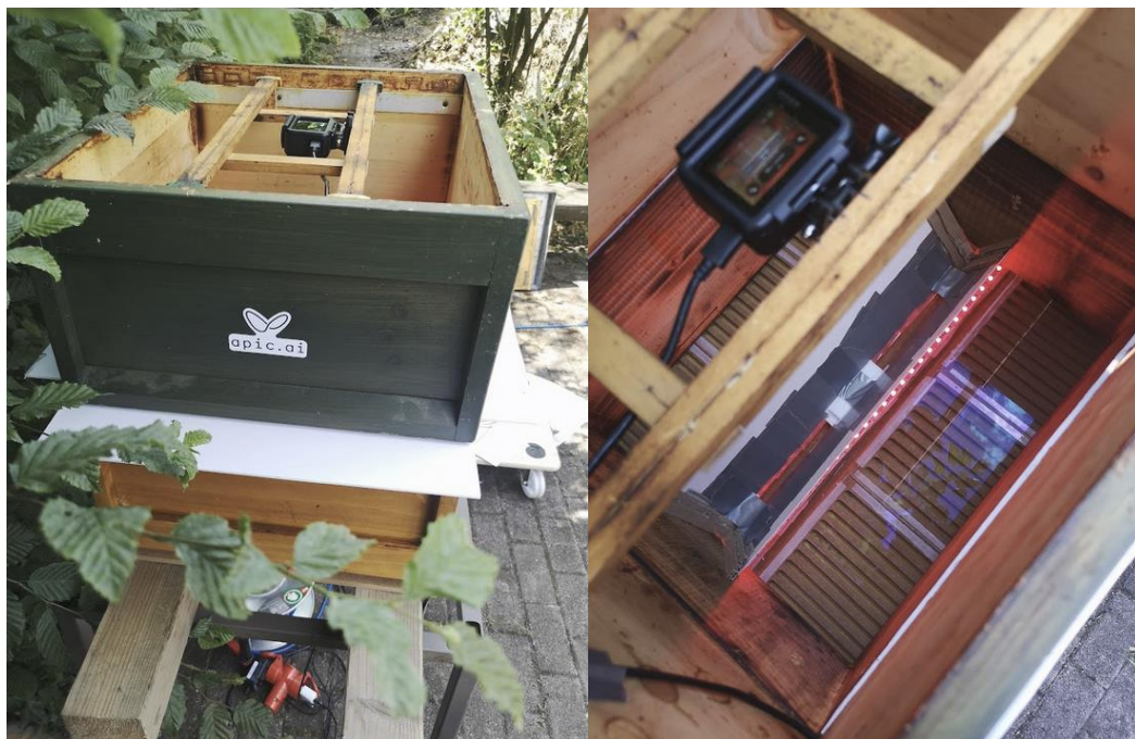
Abbildung E: Prototypischer Aufbau eines Monitoringsystems für bestimmte Wildbienen.
