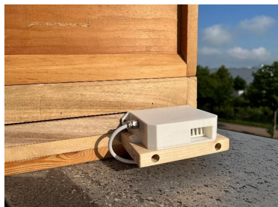
Abbildung 11: Funktionsfähige Prototypen der Königinnensperre im Versuchsaufbau
