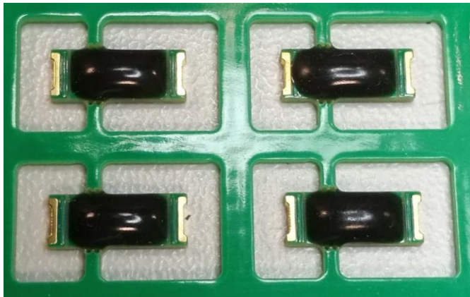
Abbildung 13: Modul-Substrat mit Miniatur-Batterien und Glob-Top
