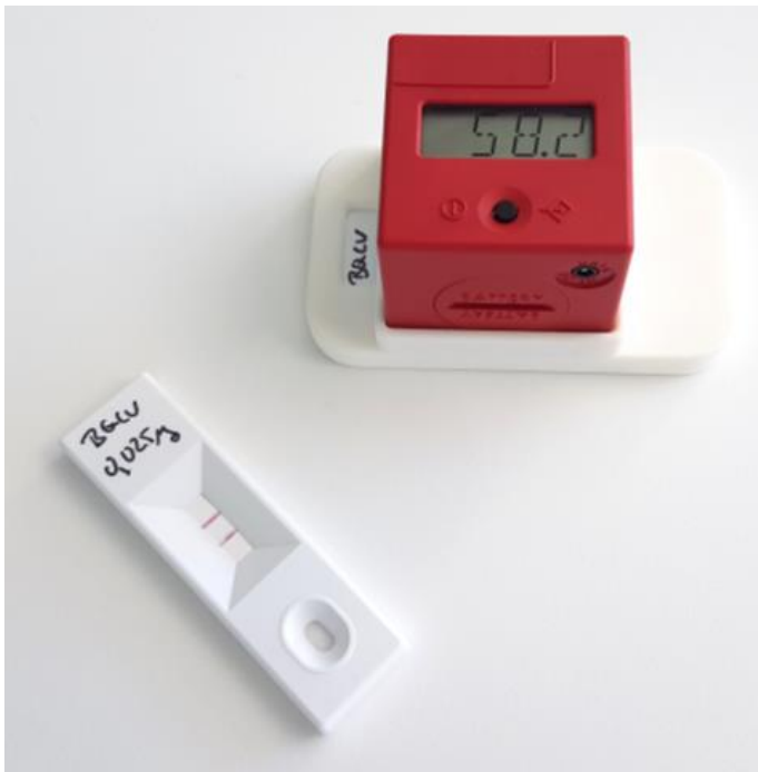
Abbildung 4: Auslesung und Quantifizierung des LFA mit dem Cube Reader von Chembio/opTricon
