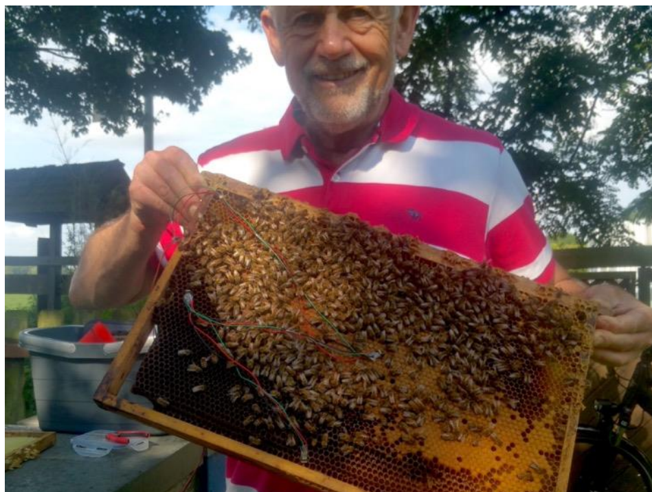
Abb. 2: Johann v.d. Bongard mit einer Brutwabe und mehreren Temperatursensoren. Für die Einstellung der Temperatur in den Brutschränken konnten mit der Messkampagne wertvolle Erkenntnisse gewonnen werden. Vom dauerhafter Einsatz der Sensorik in den brütenden Völkern zur Überwachung versprechen wir uns jedoch nur einen moderaten Nutzen, der den Aufwand nicht lohnt.
