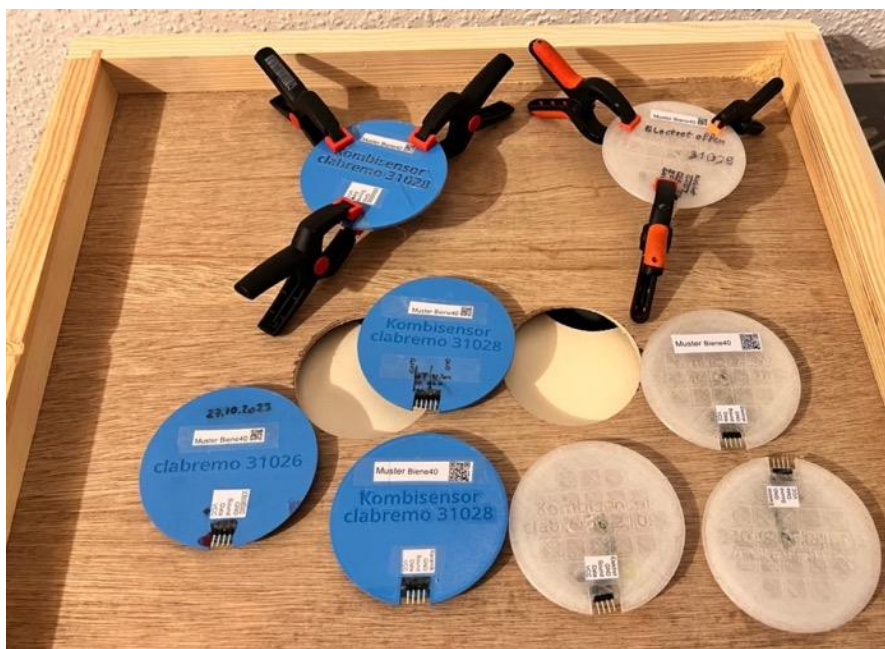
Abb. 4: Sound- und Temperaturkombinationssensoren für den Einbau in den Innendeckel. Die Sensoren schließen innen bündig ab und lassen sich mit dem Stockmeißel reinigen. Kabel sind unter dem Blechdeckel erforderlich, müssen aber nicht durch den Brutraum geführt werden - trotzdem stören sie bei imkerlichen Arbeiten in einer Berufsimkerei, bei der Zeiteffizienz am Stand unverzichtbar ist und eine Verkabelung Aufmerksamkeit bindet. Damit ist der ansonsten funktionierende Aufbau für besondere Untersuchungen, nicht jedoch für die Ausrüstung aller Beuten vorbehalten.
