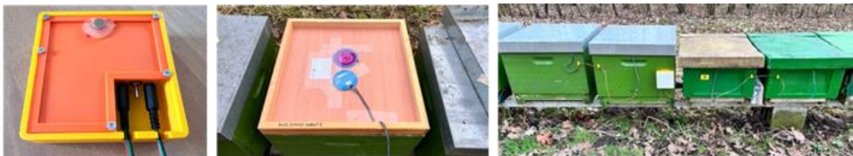
Abb. 6: Prototypen der Temperatursensoren im Feldtest. Der Sensor passt bündig in Beuten-Innendeckel und lässt sich mit dem Stockmeißel reinigen. V.l.n.r.: WLAN- Sendeeinheit mit Mikrocontroller, mehrere Beuten, die mit den Sensoren ausgestattet sind.
