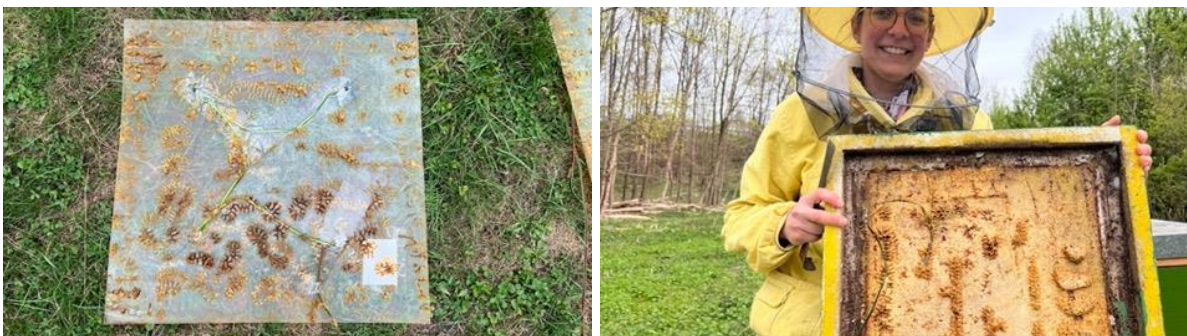
Abb. 7: links: Fixierung von Temperaturfühlern auf Abdeck-Fix für die Verwendung in Dadant-Holzbeuten. Damit lässt sich gut die Position des Bienenvolks in der Beute lokalisieren. Die Sensoren sind allerdings nach wenigen Monaten verbaut, die Kabel angefressen, das ist eine Lösung zur Beantwortung von Forschungsfragen, aber keine Hilfe in der Imkereipraxis. rechts: Temperatursensoren in Kombibeuten. Die Sensoren waren auf dem Oberträger aufgelegt, die Bienen haben sie mit Wachs am Beuten-deckel verbaut.
