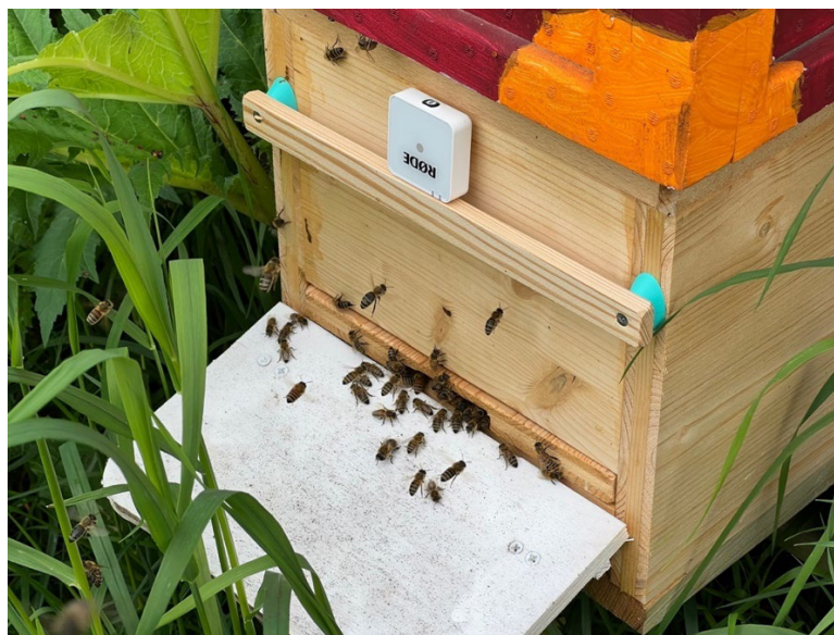
Abb. 9: Bienen am Flugloch von Meterbiene. Mit einer am Markt bereits verfügbaren Funkmikrofontechnik wurden Referenzaufnahmen erstellt, die für die Kalibrierung der im Projekt entwickelten Vibrationsensoren genutzt werden.
