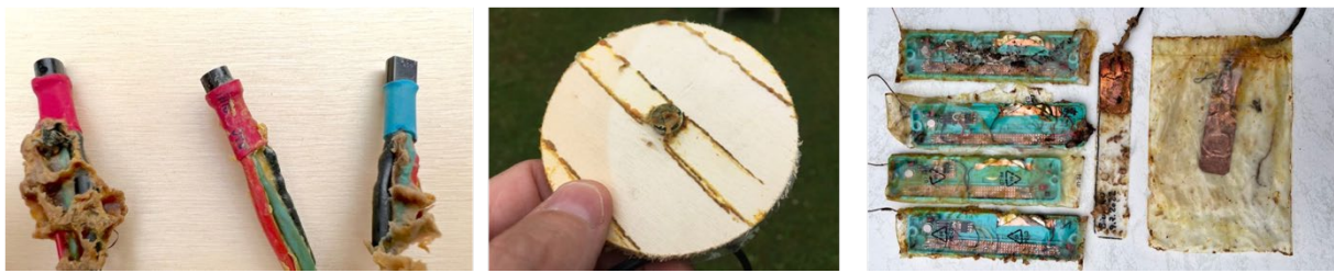
Abb. 7: Wenig erfolgversprechende Sensorik im Innenraum von Bienenstöcken. Bienen versuchen, Sensorik aus ihrem Lebensumfeld herauszuhalten. Links: Bienen zerfressen Isolierungen, z. B. Schrumpfschlauch. Weichmacher aus PVC-Isolierungen wird herausgelöst, Kabel werden steif und brüchig. Kupfer ist mehrere 10 cm in die Isolierung hinein korrodiert. Mitte: Bienen zerfressen das Filz auf Elektret-Messmikrofonen. Das kleine Loch in der Metallkappe wird mit Propolis verfüllt. Die Stockluft sorgt für eine rapide Alterung des Mikrofons. Nach vier Monaten im Stock ist ein Elektret-Mikrofon ohne Funktion. Rechts: Funktionsfähige, aber angegriffene Sensoren, die eine Weile auf dem Oberträger gelegen haben. Lebensmittelechte Polyethylenhüllen werden von Bienen zerfressen. Was nicht zerfressen wird, erhält einen Propolis- und Wachs-Überzug. Geeignetes Reinigungsmittel: 40% Benzin, 40% Ethanol, 20% A.dest. Das reinigt allerdings auch Weichmacher aus Kunststoffen wie Kabelisolierungen heraus.
