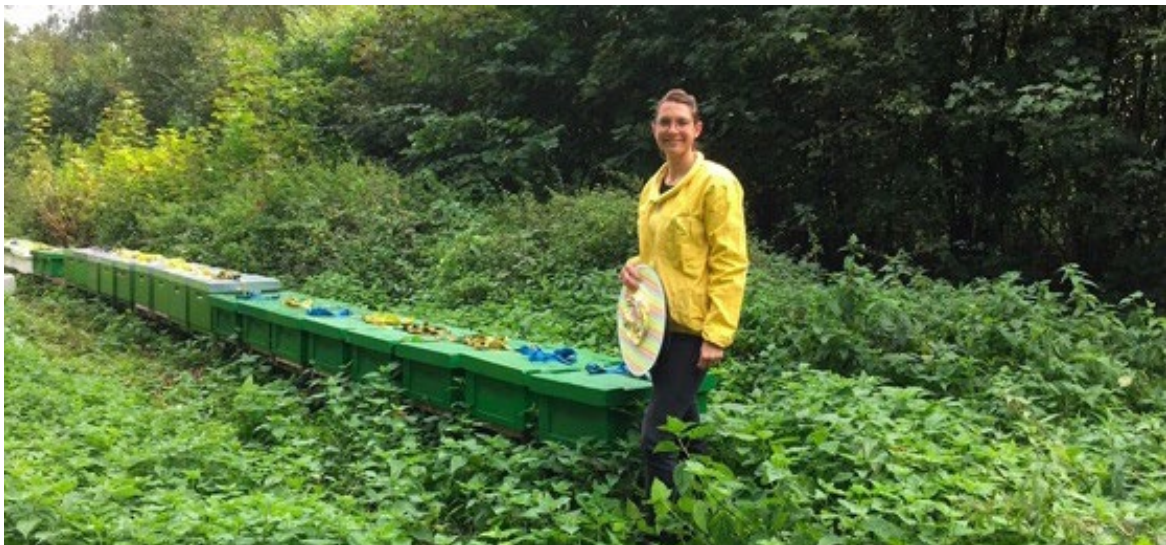
Abb. 1: Teststand mit 20 Bienenvölkern, zehn in Styropor (Kombisystem) und zehn in Holz (Dadant 12er). Der Teststand befindet sich in einem Autobahndreieck. Dadurch entstanden viele praxisnahe Audioaufnahmen mit zu erwartenden Störungen. Der Teststand wurde vom Projektpartner Bienenland - auf dem Bild Imkermeisterin Iris van den Bongard - aufgebaut und unterhalten.
